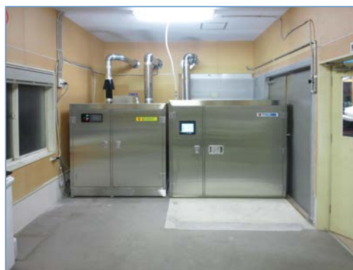
「燦マットレス消毒機RCM-S」 「燦スピンウォッシャー車椅子洗浄消毒機」
