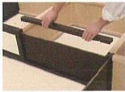
(4) 上枠の取付け
