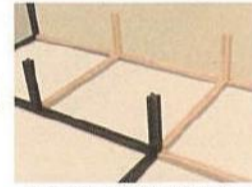
(2) 柱と下枠の組立て
