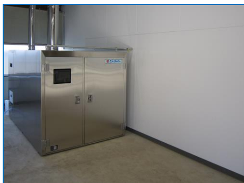
燦クリーンキーパーMCM-3S ウレタンマットレスは蒸気消毒
